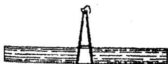
Схема строповки металлической трубы
